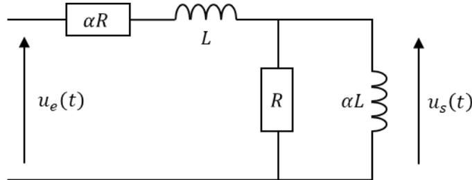
Ce circuit peut être réglé en adaptant la valeur du paramètre  $\alpha \in ]0 ; 2]$ . On donne  $R = 1,00 \text{ k}\Omega$  et  $L = 100 \text{ mH}$ .
